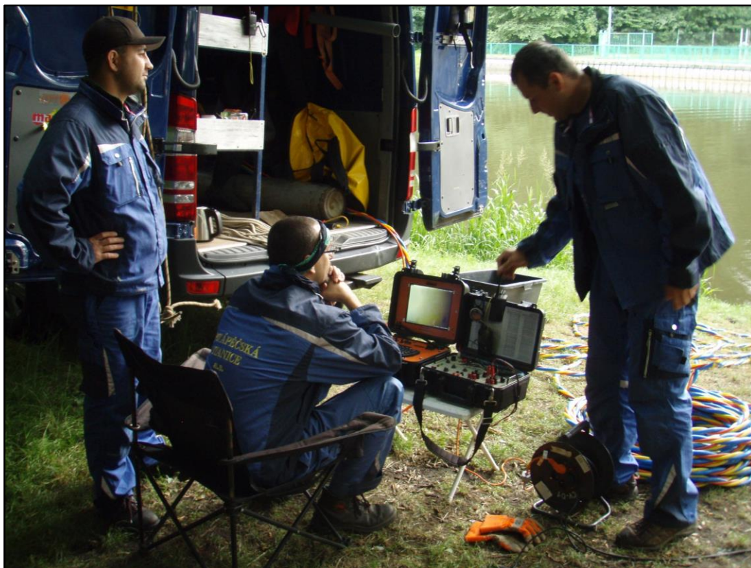
Foto č. 2 – Příprava potápěčské a komunikační techniky před zahájením prací
